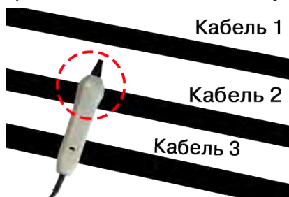
Выбор кабеля по максимальному сигналу
